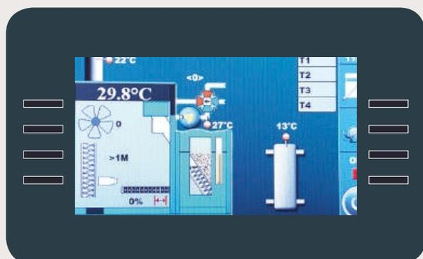
Les menus vous permettent d'avoir accès aux fonctions de paramétrage de la chaudière (alimentation automatique, combustion, ...)
