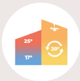
L'air chaud étant plus léger que l'air froid, celui-ci a tendance à remonter, entraînant une différence de température entre le sol et le plafond du bâtiment. Plus la hauteur du bâtiment est importante, plus la différence de température est élevée.
